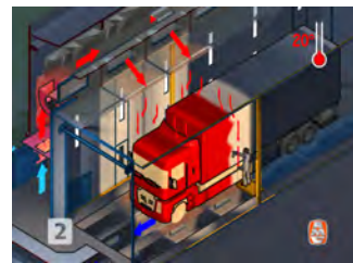
▲ Schéma de la cabine de peinture "multizône ® ".
